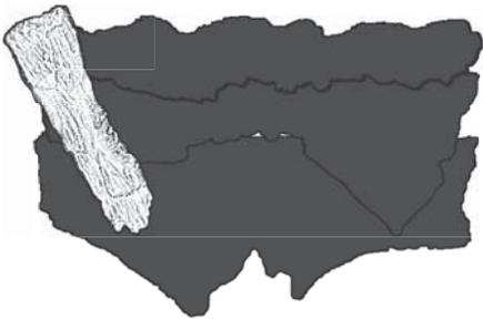
**D.** Installez la bûche droite (W135-0407) sur le dessus de la bûche centrale en plaçant les trous rectangulaires sous la bûche sur la partie saillante de la bûche centrale. L'encoche à l'autre extrémité de la bûche reposera contre l'arrière de la tige droite de la grille avant.
