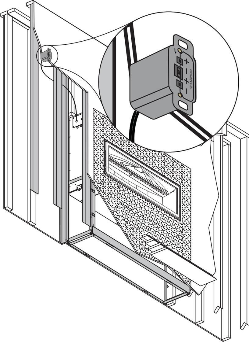
Le récepteur doit être situé à une distance maximale de 8 pieds de ce côté de l'appareil et doit être accessible pour programmer la télécommande. Installez le récepteur dans un boîtier électrique standard. Déterminez un emplacement approprié et installez le boîtier électrique.
