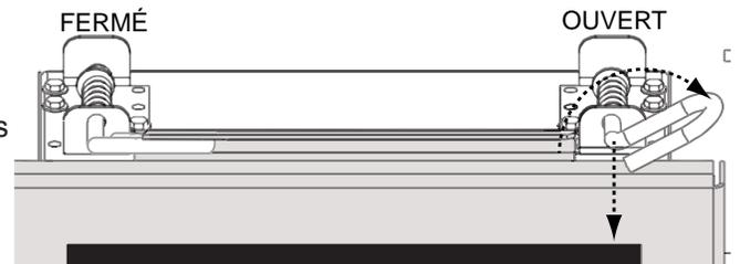
Inversez ces étapes pour réinstaller l'écran de protection et la porte. Assurez la écran de protection est correctement installé.
