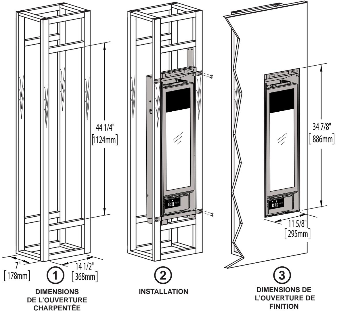
**NOTE :** L'ouverture de finition est plus petite que l'ouverture charpentée. Nous conseillons d'installer le Flambeau<sup>MD</sup> au centre du mur afin d'être au niveau des yeux.
