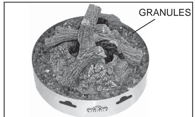
**4.1.6** L'appareil est fourni avec 3 lb de pierres de lave qui peuvent toutes être versées dans l'anneau extérieur. Vous pouvez les mélanger ou les étendre en couches, en mettant le type de granules désiré sur le dessus. **NE PLACEZ PAS LES GRANULES SUR LE BRÛLEUR.**
