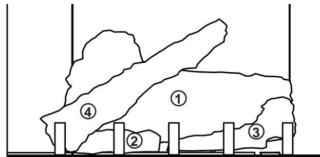
Placez la bûche #1 sur le brûleur, en prenant soin de la centrer sur le plateau du brûleur et en la poussant le plus près possible du mur arrière de la chambre de combustion. Placez les bûches # 2 et 3 à leur place, tout en alignant les tiges situées sur le brûleur avec les trous sous les bûches. Placez l'encoche située au bas de la bûche #4 contre le poteau le plus à gauche du chenet et placez le haut de la bûche dans la rainure qui se trouve sur la bûche arrière (#1).
