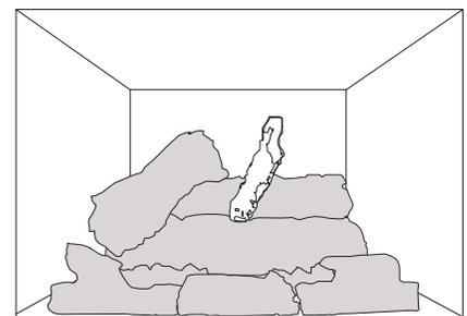
**9.** Placez la bûche transversale centrale sur la tige centrale de la bûche arrière. Placez l'extrémité de la bûche dans la fente de la bûche centrale.
