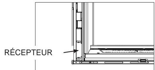
Si vous devez enlever le récepteur, retirez le panneau d'accès gauche du devant de l'appareil. Enlevez les deux vis servant à fixer le récepteur. Tirez le récepteur à travers l'ouverture d'accès puis remplacez.
