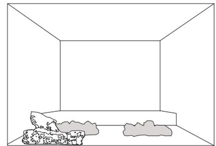
**3.** Mettez le morceau de charbon avant gauche\* en place, en alignant les trous sous le morceau de charbon avec les tiges du coin avant gauche.
