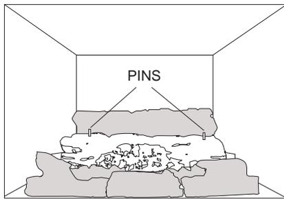
**7.** Mettez la bûche centrale derrière le brûleur à plateau, en alignant les trous avec les quatre tiges et en vous assurant que la bûche soit à plat sur la base. Insérez deux tiges dans les trous supérieurs gauche et droit.
