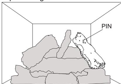
**10.** Placez la bûche transversale droite sur les tiges sur le côté droit des bûches centrale et arrière. Insérez une tige sur le dessus de la bûche.
