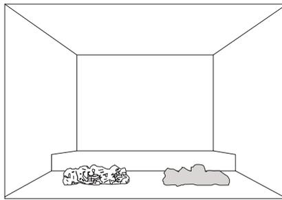
**2.** Mettez le morceau de charbon gauche en place, en alignant les trous sous le morceau de charbon avec les tiges situées sur le côté gauche du brûleur.
