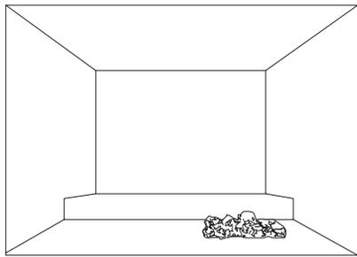
**1.** Mettez le morceau de charbon droit en place, en alignant les trous sous le morceau de charbon avec les tiges situées sur le côté droit du brûleur.
