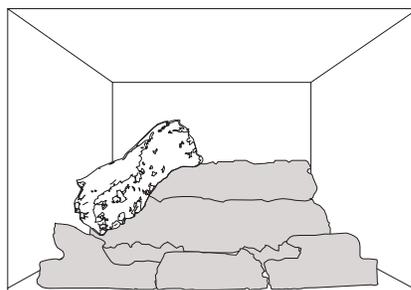
**8.** Placez la bûche transversale gauche sur les tiges sur le côté gauche des bûches centrale et arrière.
