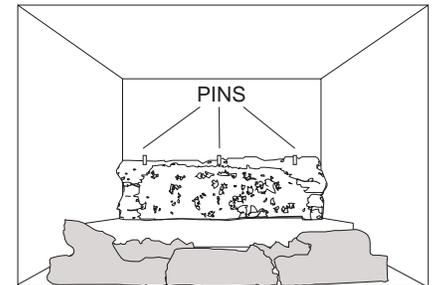
**6.** Mettez la bûche arrière contre le panneau arrière, en alignant les trous avec les tiges situées à l'arrière de la chambre de combustion. Insérez 3 tiges (fournies) sur le dessus de la bûche.
