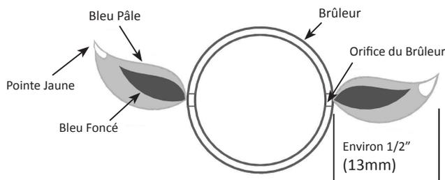
**Brûleur Tube:** Le brûleur est fait d'acier inoxydable 304, mais en raison de la chaleur extrême et d'un environnement corrosif, il se produira une corrosion de surface. Enlevez cette corrosion à l'aide d'une brosse en laiton. Nettoyez les orifices bouchés à l'aide d'un trombone déplié. N'agrandissez surtout pas les orifices du brûleur.
