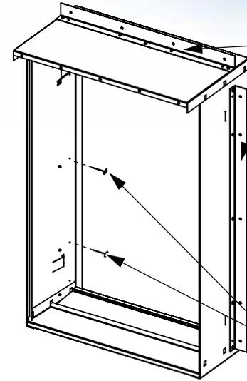
POUR PLUS DE SOLIDITÉ ET POUR RÉDUIRE LES VIBRATIONS DU SUPPORT MURAL, DES SUPPORTS PEUVENT ÊTRE UTILISÉS POUR FIXER LE MANCHON MURAL À LA SOUS-STRUCTURE DE L'ÉDIFICE À PARTIR DE L'INTÉRIEUR OU DE L'EXTÉRIEUR DE L'ÉDIFICE. INGÉNIEUR/ARCHITECTE – CONSULTEZ LE SERVICE D'INGÉNIEURIE DE NAPOLÉON POUR DÉTERMINER L'EMPLACEMENT DES SUPPORTS EN FONCTION DE LA PROFONDEUR DE MANCHON MURAL DÉSIRÉE.
